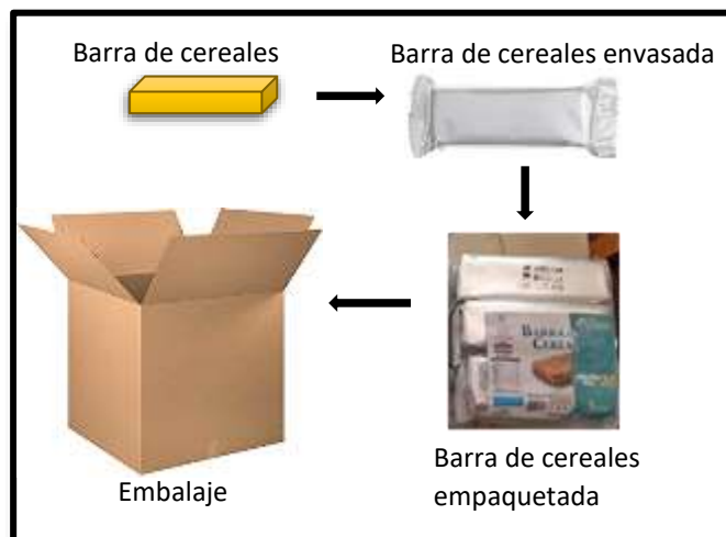
Figura 3.11. Proceso de empaquetado y embalaje
