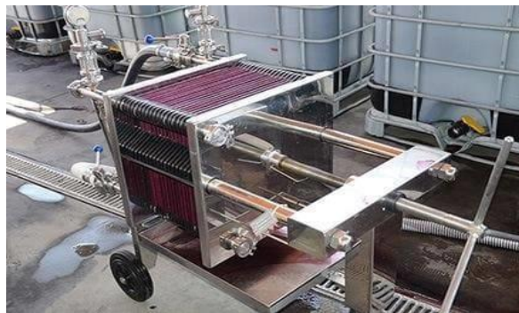
Fig. 3-2. Filtro de Placas.
