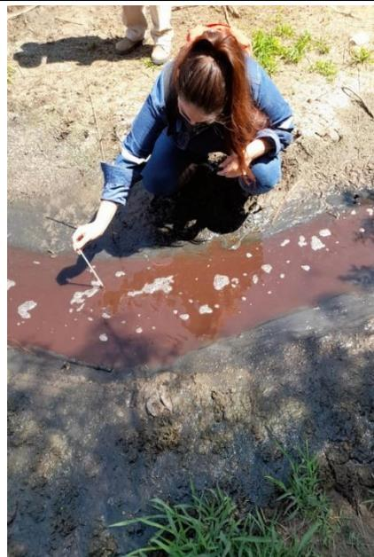
Se realizo la medición de la temperatura debido a que es uno de los parametros mas importantes en el agua.
