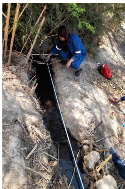
Se realizó la medición del caudal para determinar si es constante.
