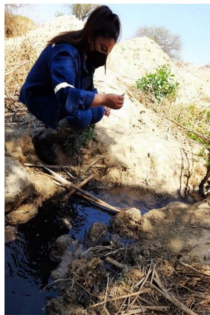
Se realizo la medición debido a que el oxígeno disuelto es dependiente de la temperatura.
