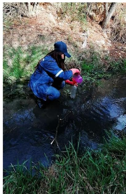
Muestra de 2000 ml, tomada del P3 cerca de terrenos baldíos para la determinación de la contaminación.
