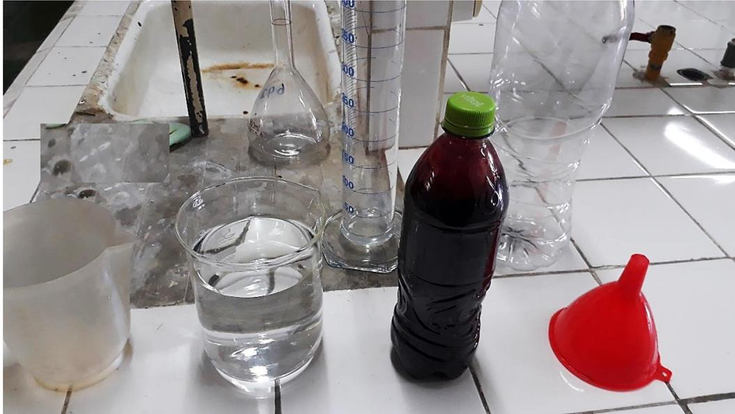
Materiales utilizados para realizar analisis del DBO5 de la solución de sangre del efluente del Matadero Frigorífico Municipal en laboratorio, usando agua destilada, para comparar con resultados del cuerpo receptor.
