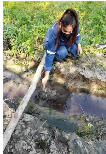
Se realizó la medición debido a que el oxígeno disuelto es dependiente de la temperatura.
