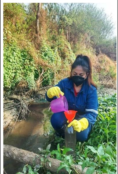
Muestra tomada de 2000 ml, tomada del P4 ubicada en el límite entre la Quebrada Cabeza de Toro y el cuerpo receptor río Guadalquivir, para la determinación de la contaminación.
