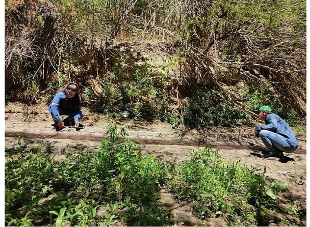
Se realizó la medición del caudal para determinar si es constante.
