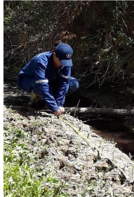
Se realizó la medición del caudal para determinar si es constante y para determinar si existe una autodepuración.
