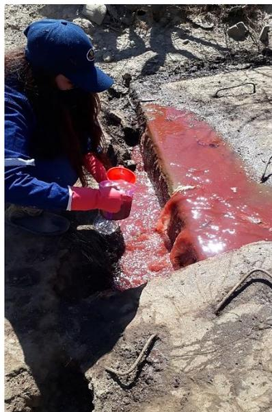
Muestra para analizar, Según la NB 64002 el lugar de muestreo corresponde al punto final de la descarga de aguas residuales de origen industrial.
