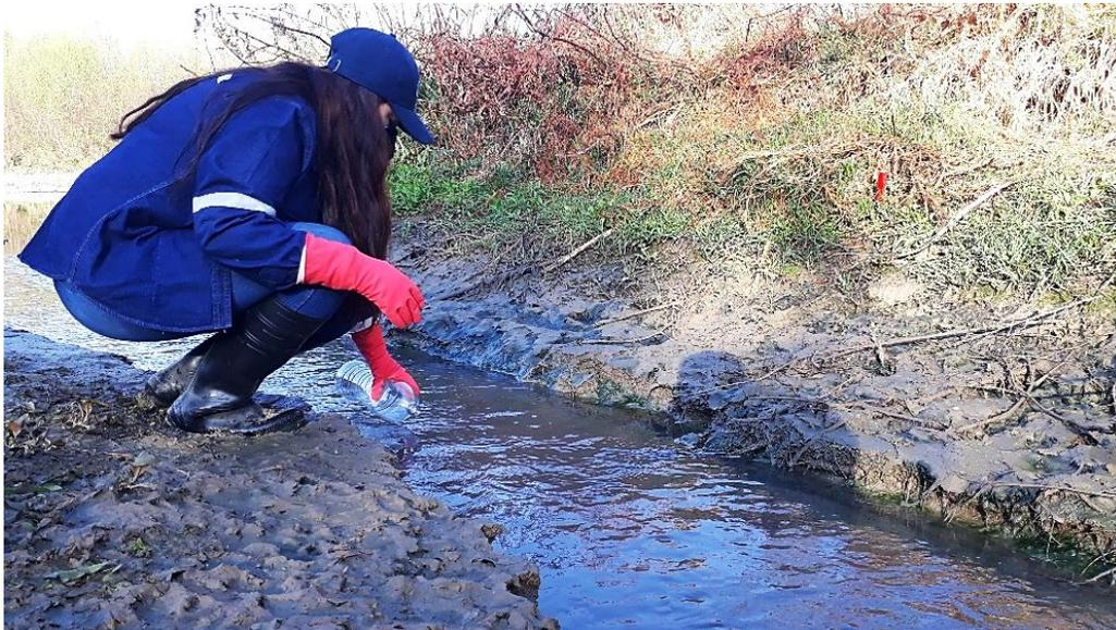
Muestra tomada de 2000 ml, para la determinación de la contaminación.
