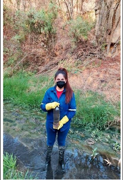
Muestra de 2000 ml, tomada del P3 cerca de terrenos baldíos para la determinación de la contaminación.
