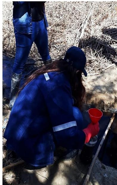
Muestra de 2000 ml, tomada del P2 cerca de un terreno de cultivo de chacra para la determinación de la contaminación.
