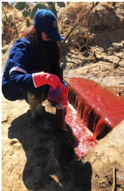
Muestra de 2000 ml, tomada del P1 efluente del Matadero Frigorífico Municipal para la determinación de la contaminación.
