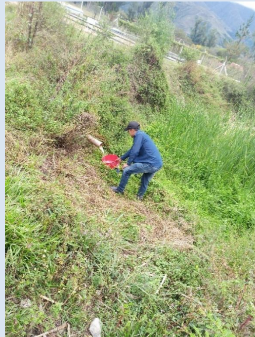
IMAGEN 12: Captura del agua tratada y medición del caudal.
