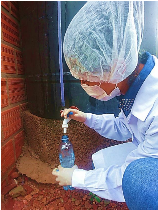
Foto 29, 30, 31, 32: Toma de la segunda muestra para análisis físico-químico.
