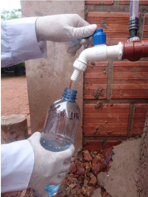
Foto 21, 22, 23, 24: Toma de la primera muestra para análisis físico-químico.
