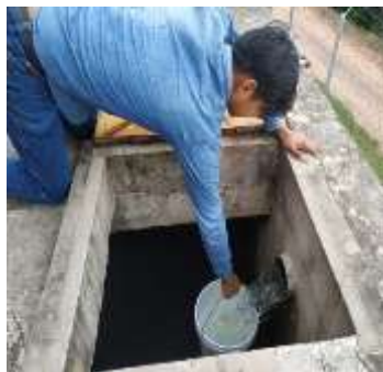
Imagen 26. Medición de Caudal del Tanque 1.
