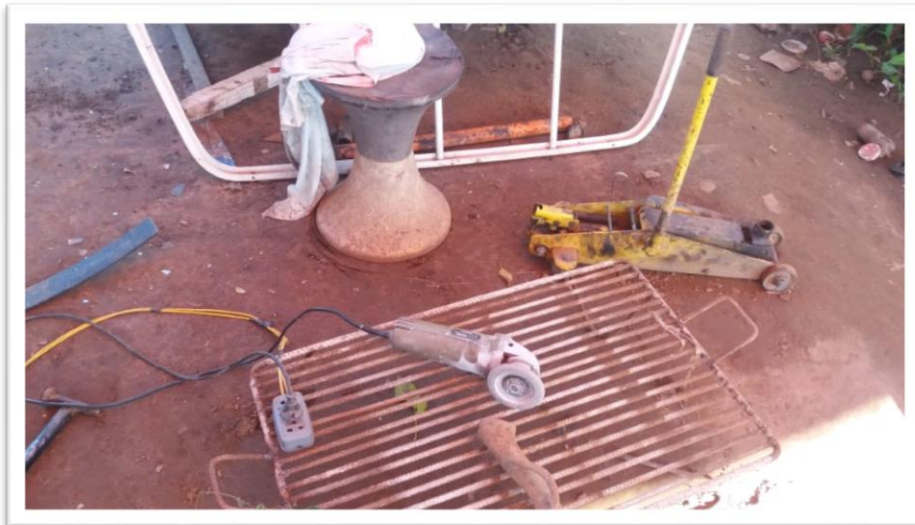
CABLES EN ZONA DE PASO
