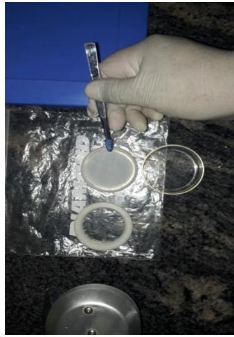
Colocado de filtro en el portafiltro
