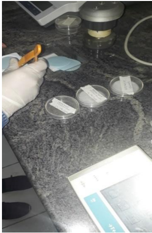
Pesaje de filtros expuestos
