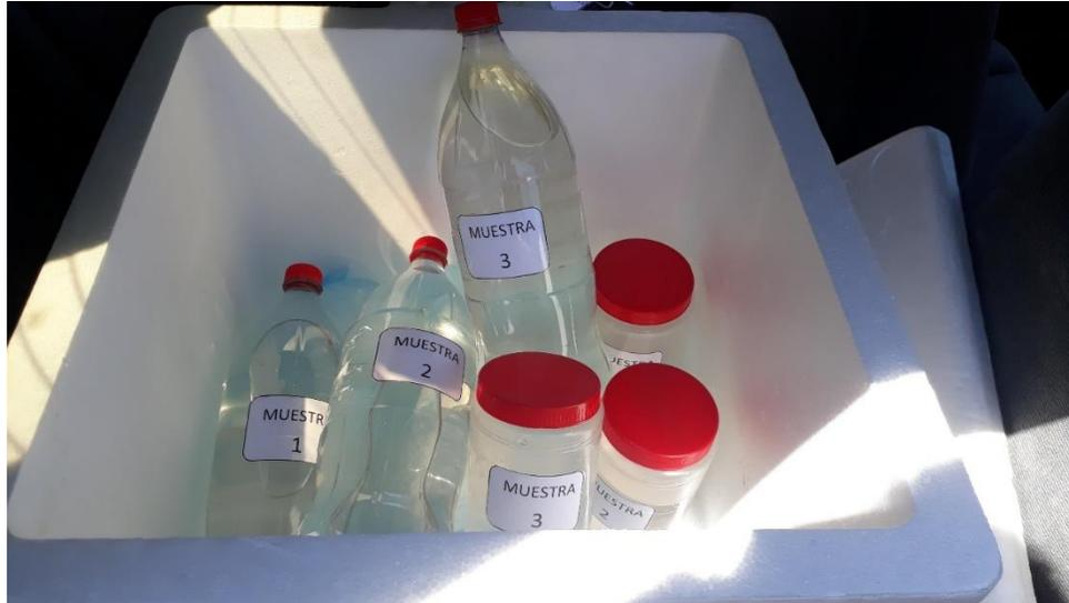
Para las muestras se emplearon frascos esterilizados otorgados por el “CEANID” para el análisis bacteriológico, y botellas pet esterilizadas para el análisis físico-químico y una conservadora con hielo para mantener la cadena fría.
