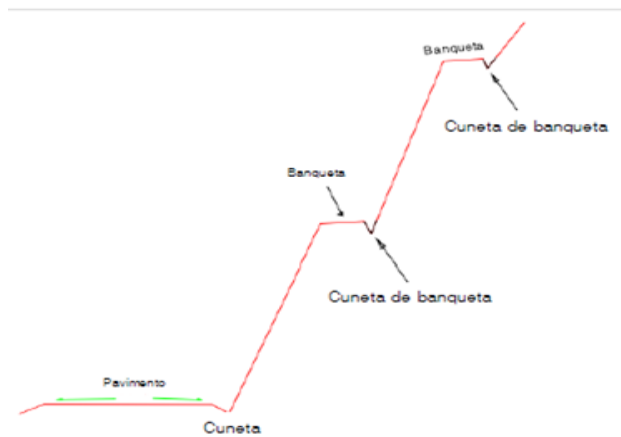
Grafica 3 CORTE DE TALUD ADECUADO
