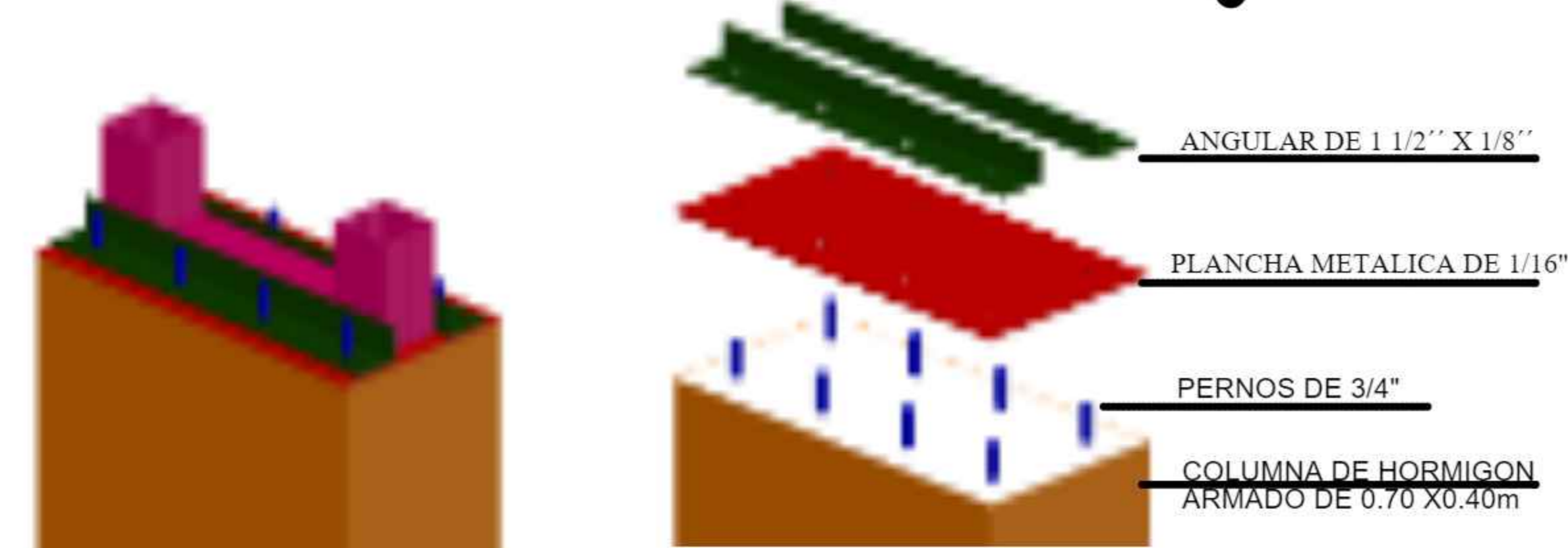
DETALLE CONSTRUCTIVO DE ESCALERA ESC. 1:25
