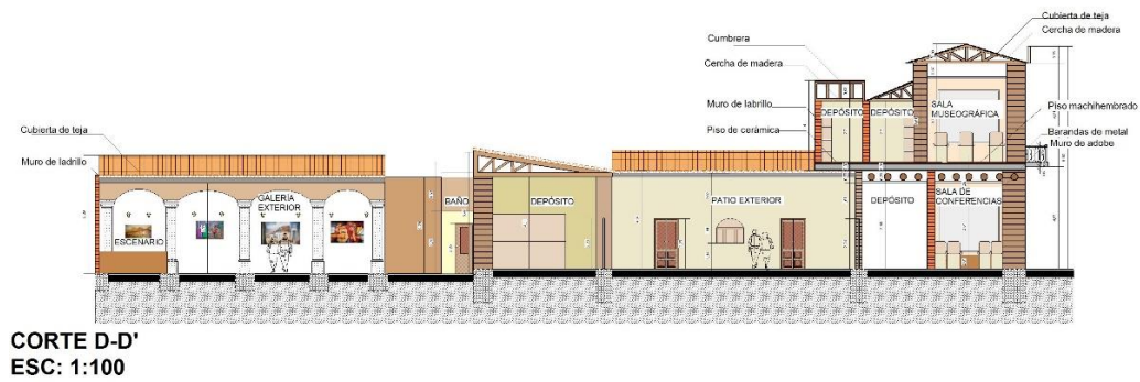
Figura 82. Corte D-D', readecuación a museo de artes plásticas.
