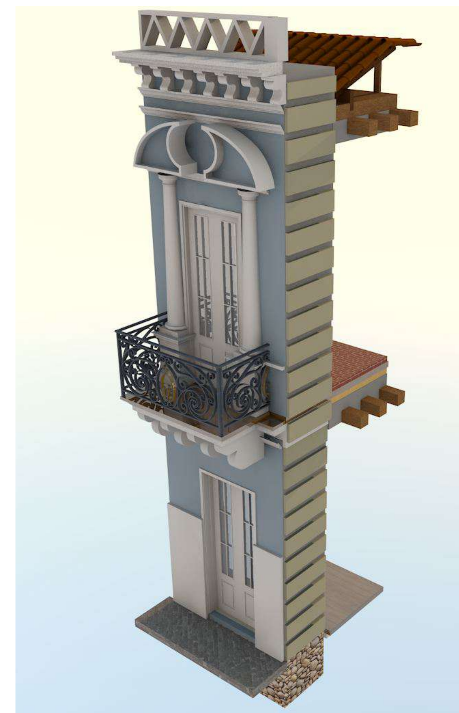
CORTE DE BORDE DEL SISTEMA ESTRUCTURAL
