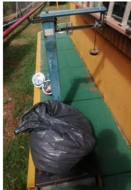
EL PESAJE DE LOS RESIDUOS SOLIDOS Y PELIGROSO LO HACEN DE DOS MANERAS CORRESPONDIENTES A TRAVES DE UN PESAJE PR ROMANA Y LA OTRA MEDIANTE UNA BALANZA.
