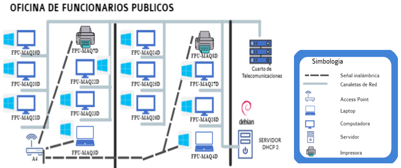
Figura 82. Diagrama de la conexión de la Oficina de funcionarios Públicos Parte 2
