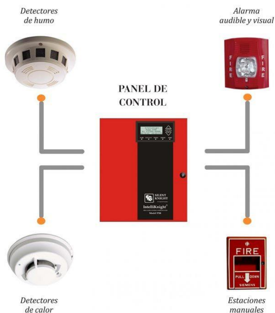
Figura 49. Sistema de detección de incendios
