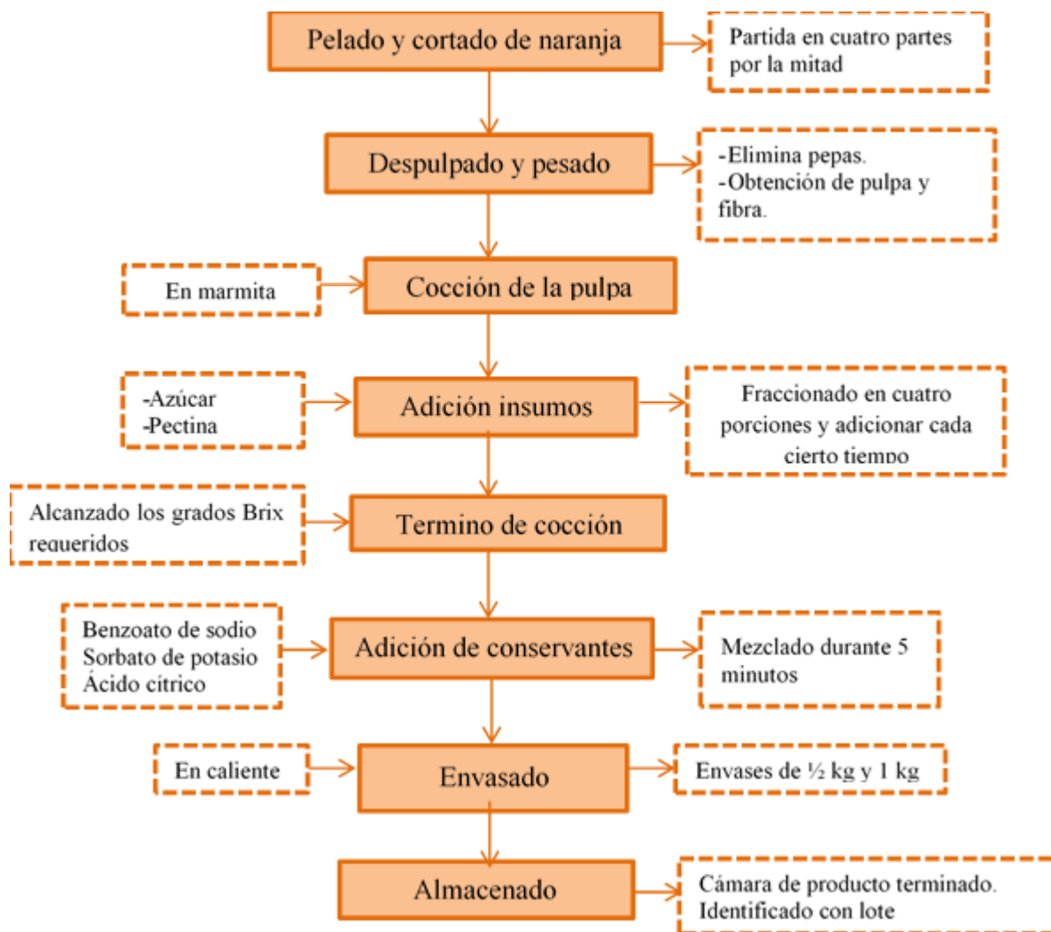
Figura 0-3:Diagrama de flujo proceso de producción de mermelada de naranja
