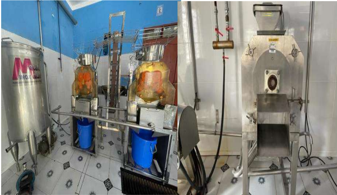
Sala de producción del CMTCC, Tanque de jugo virgen, exprimidoras, y Finisher
