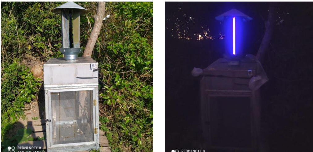
Figura 6: Trampa de luz que se utilizó para la captura de adultos.
