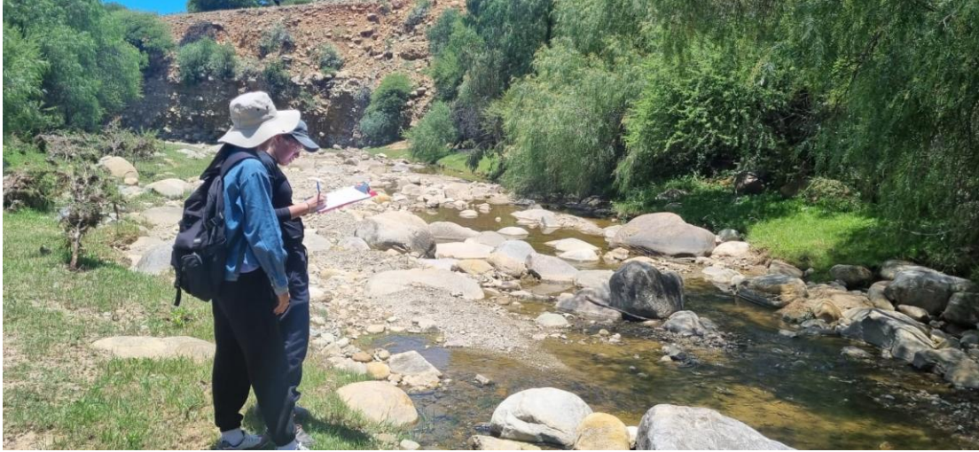
Foto 1 Medición del caudal utilizando una pelotita de plastoformo.
