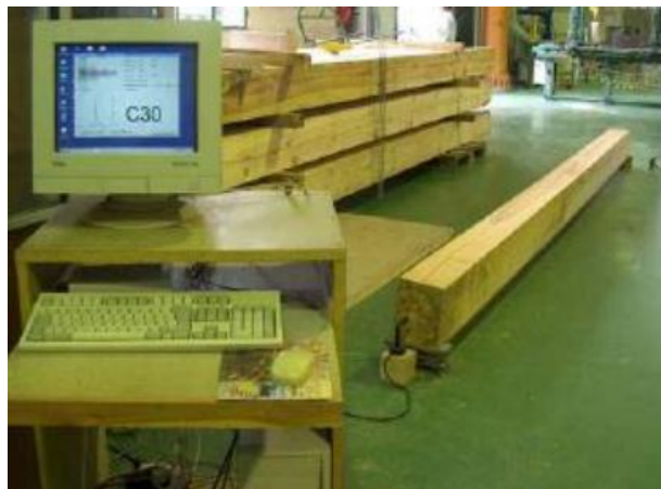
Imagen N° 19. Equipo PLG para análisis de vibraciones
