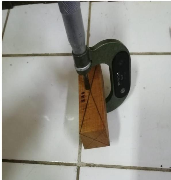
Medición de la Probeta de las caras radial y tangencial
