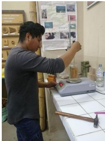
Pesado de las Probetas para sacar el volumen por el método de inmersión
