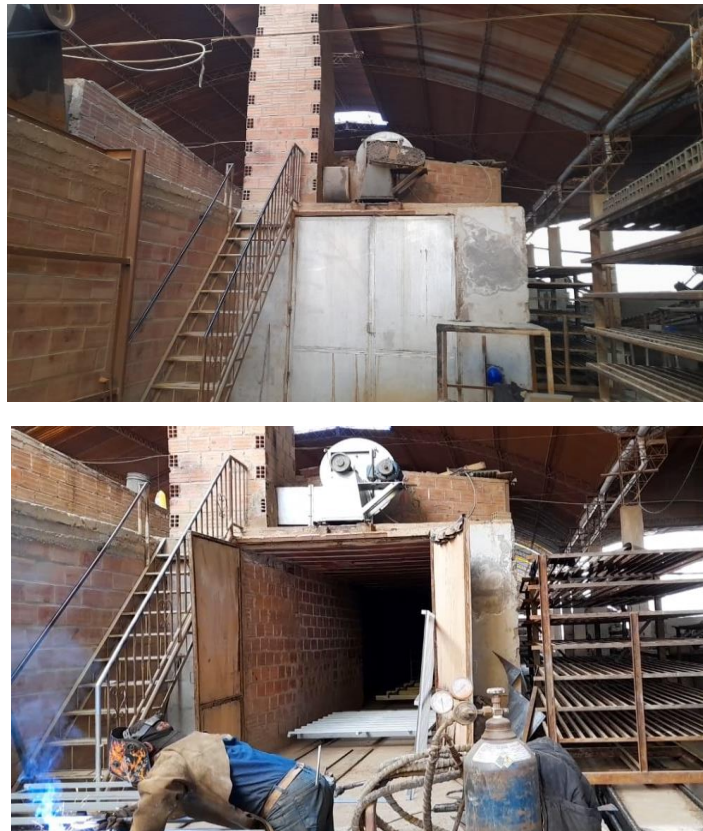
Fig. 3-2 Cámara de secado de la cerámica
