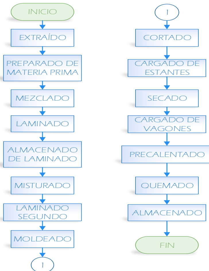
Figura 1-5 Diagrama de flujo de la cerámica Narváez S.R.L.
