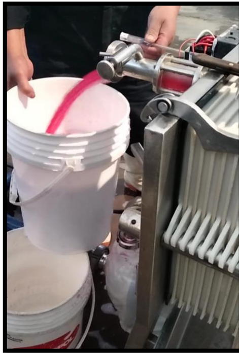
Figura 3- 4 Filtrado por placas
