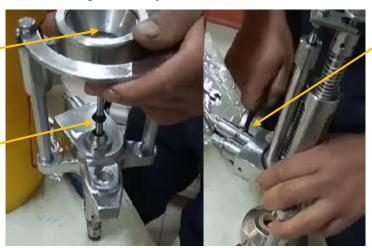
Introducir la válvula de aire pieza 16
