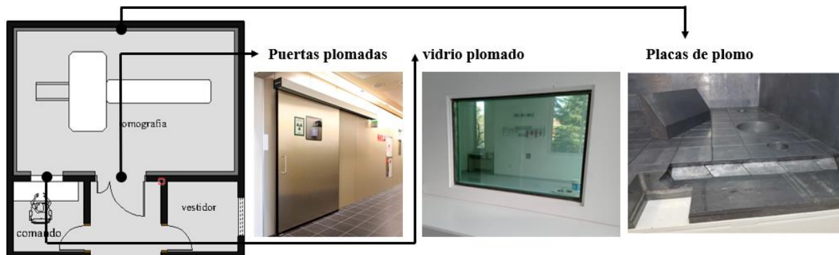
figura 48 blindaje de placas de plomo
