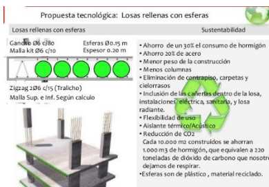
Figura 111 Losa Aligerada Prenova
