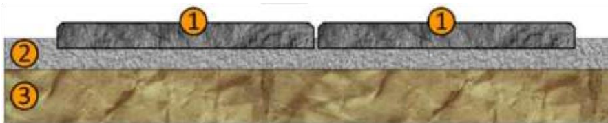
1) Baldosa 2) Cama de arena 3) Terreno compactado
