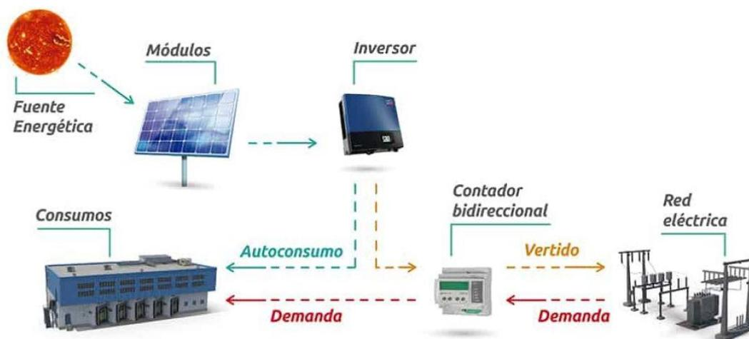
Imagen 44 Organigrama de funcionamiento de paneles fotovoltaicos
