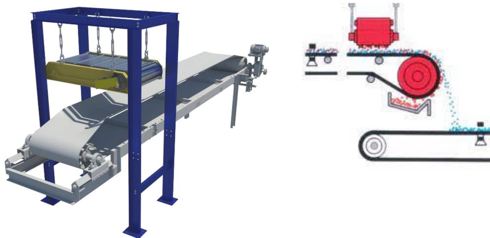
Imagen 26 Separador electro magnético y su proceso
