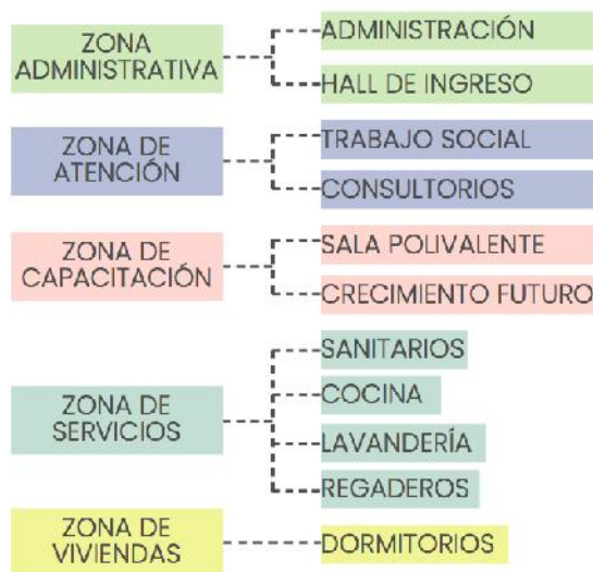
Figura 59. Programación arquitectónica del refugio
