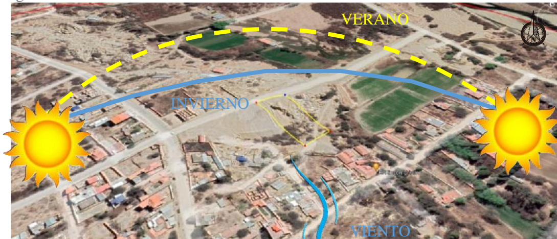
Figura 75: Asoleamiento del sitio de intervención
