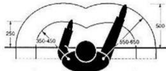
Figura 94: Arco horizontal de alcance del brazo y área de trabajo sobre una mesa (cotas en mm)
