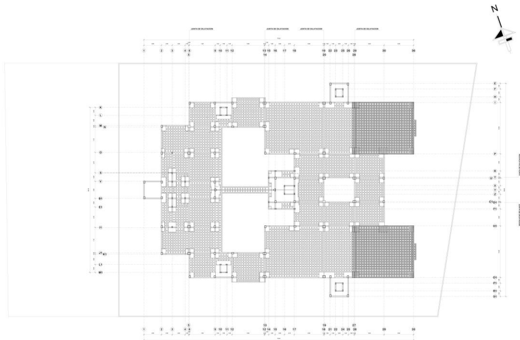
PLANTA DE ESTRUCTURA DE LOSA
