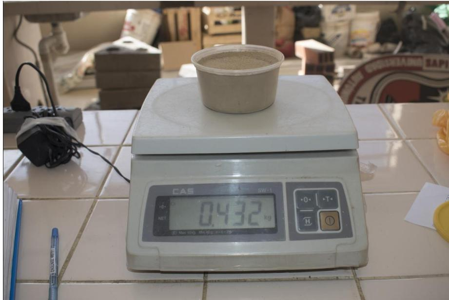
Anexo 6. Pesaje de cemento en bote de prueba.
