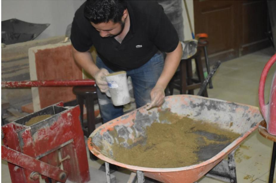
Anexo 16. Colocado de la mezcla en la prensa.
