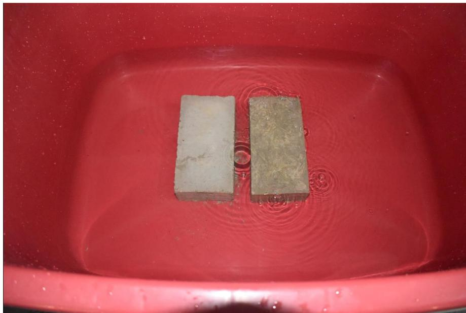
Anexo 24. Prueba de hidroscoπισidad por goteo de agua.
