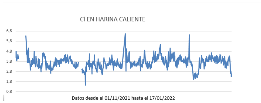
Figura 2-6 Gráficas de elementos volátiles cloro horno FLS
