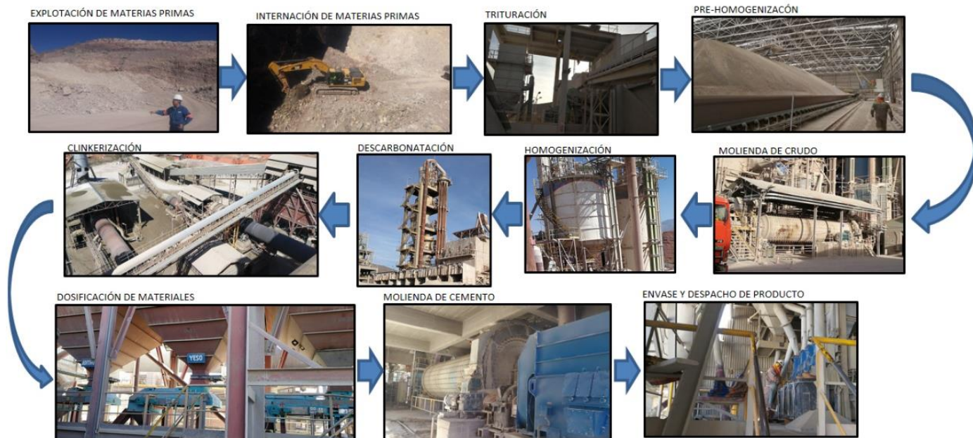
Figura 1-1 Diagrama de flujo del proceso de fabricación de cemento
