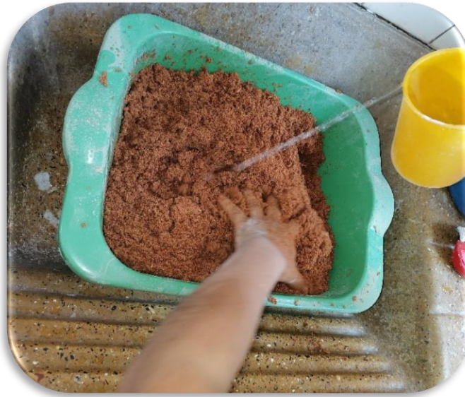
Fotografía N° 1 Preparado de la pasta remojando el aserrín
