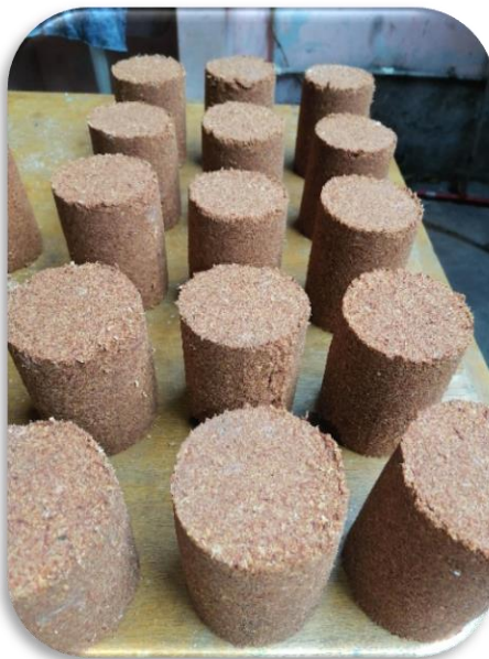
Fotografía N° 14 Briquetas con aglomerante Almidón
