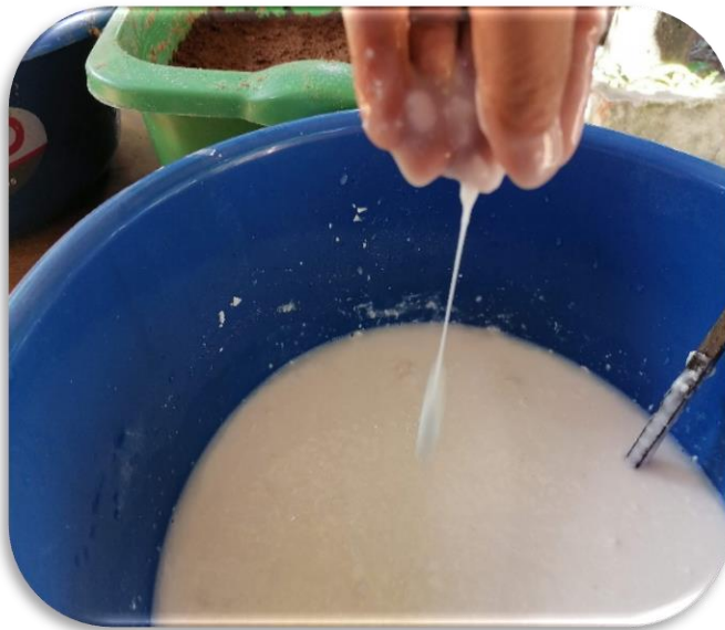
Fotografía N° 6 preparado de aglomerante almidón con agua tibia
