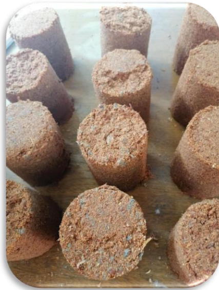
Fotografía N° 13 Briquetas con aglomerante papel periódico
