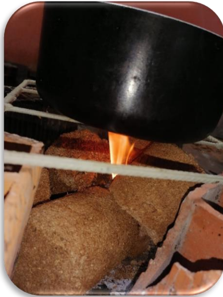
Fotografía N° 21 Prueba de hervir el agua
