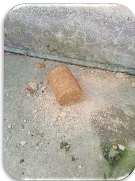
Fotografía N° 20 Prueba de friabilidad con aglomerante almidón
