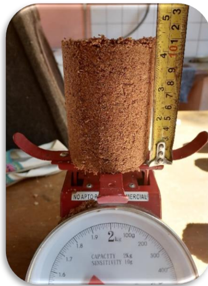
Fotografía N° 16 Medida de Briquetas
