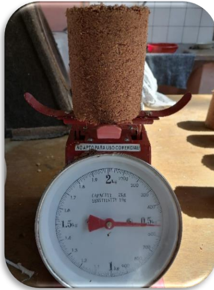
Fotografía N° 15 Pesado de briquetas
