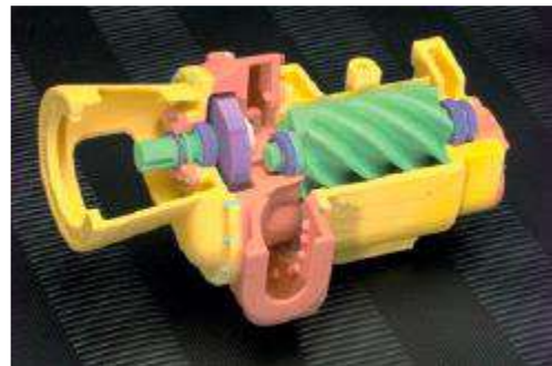
Prototipo de un mecanismo mediante impresión 3D.
