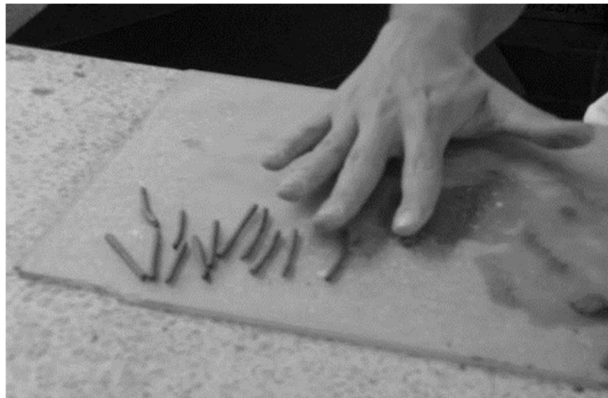
FIGURA 2.5: Ensayo de límite plástico
