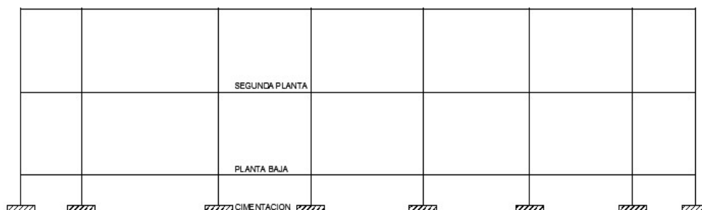
FIGURA 2.13: Planteo estructural de la estructura porticada
