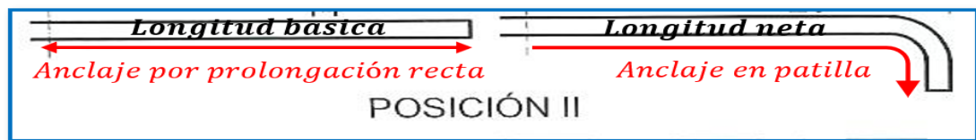
FIGURA 3. 7 Anclaje en Barras Corrugadas en Posición II
