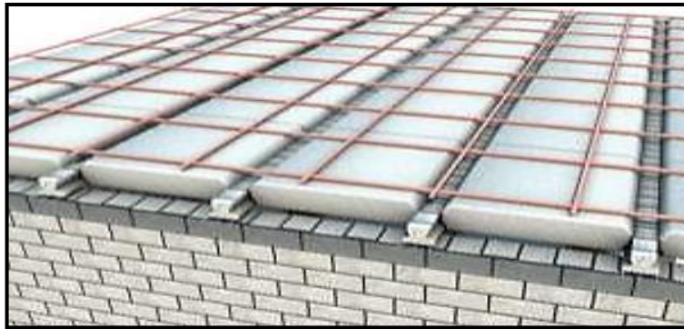
FIGURA 2. 3 Armadura de Distribución de la losa alivianada
