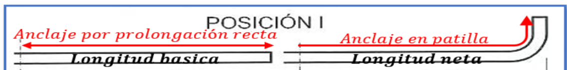
FIGURA 3. 6 Anclaje en Barras Corrugadas en Posición I
