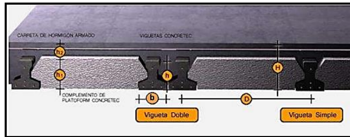
FIGURA 2. 2 Sistema de aplicación de la vigueta pretensada
