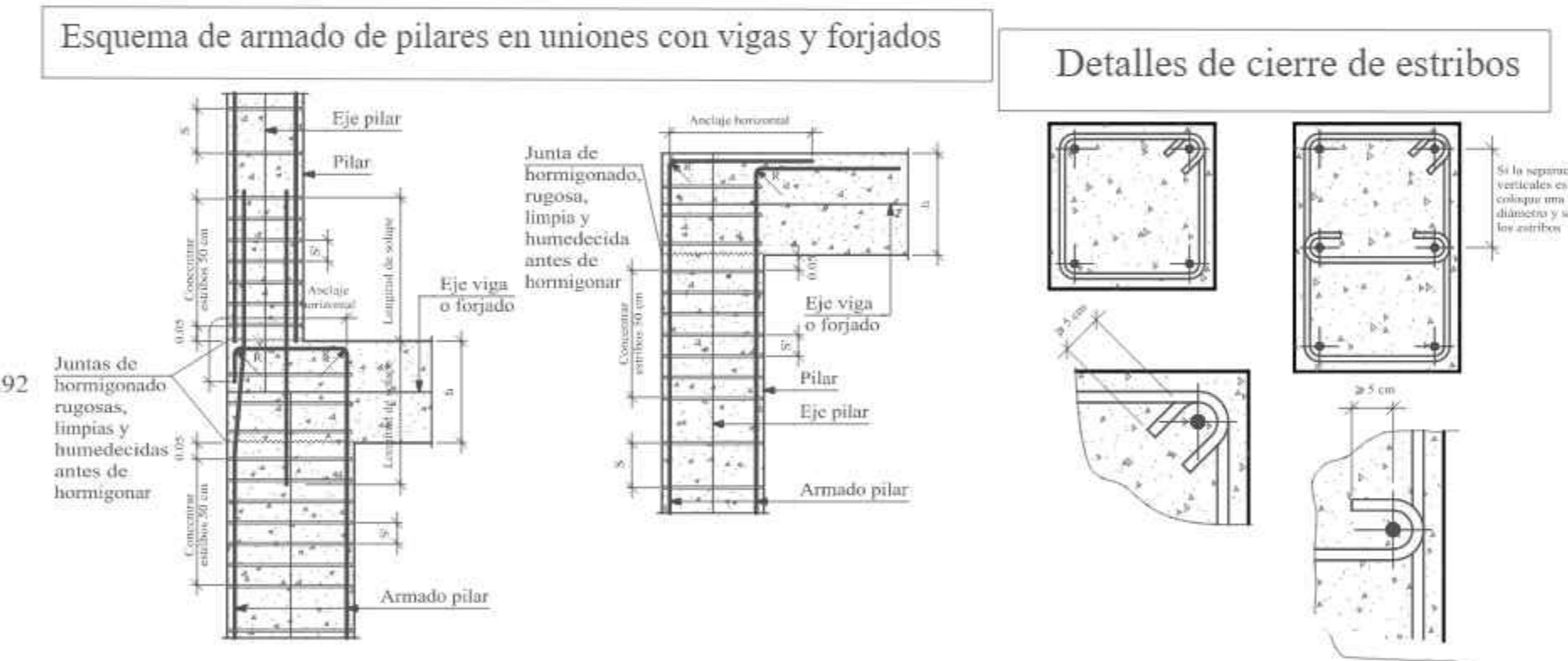
Detalle de estribos de pilares
