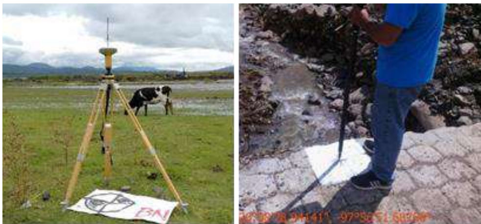
Figura 34: Levantamiento de puntos de control.
