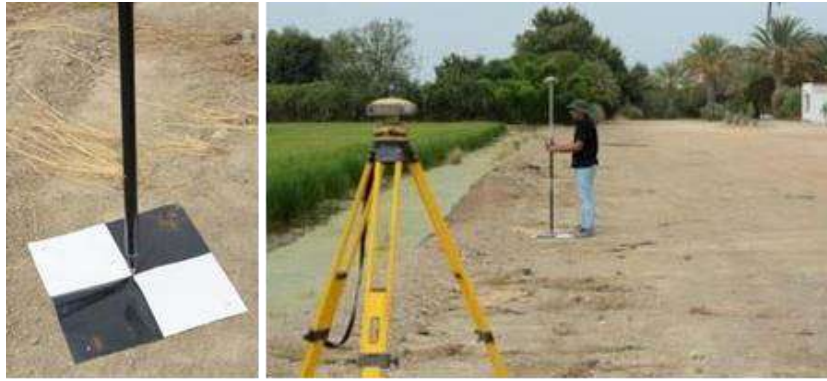
Figura 19: Dianas para la ubicación de puntos de control en el terreno (izquierda) y GPS diferencial (derecha).
