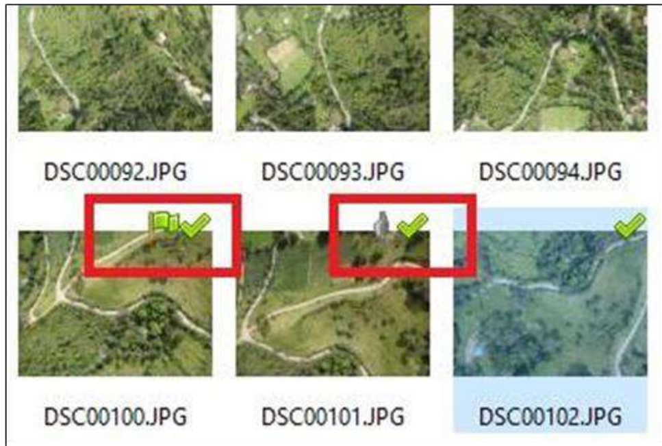
Figura 79: Imagen con punto de control e imagen con posible punto de control homologo. Fuente: Elaboración propia con el software Agisoft Metashape.
