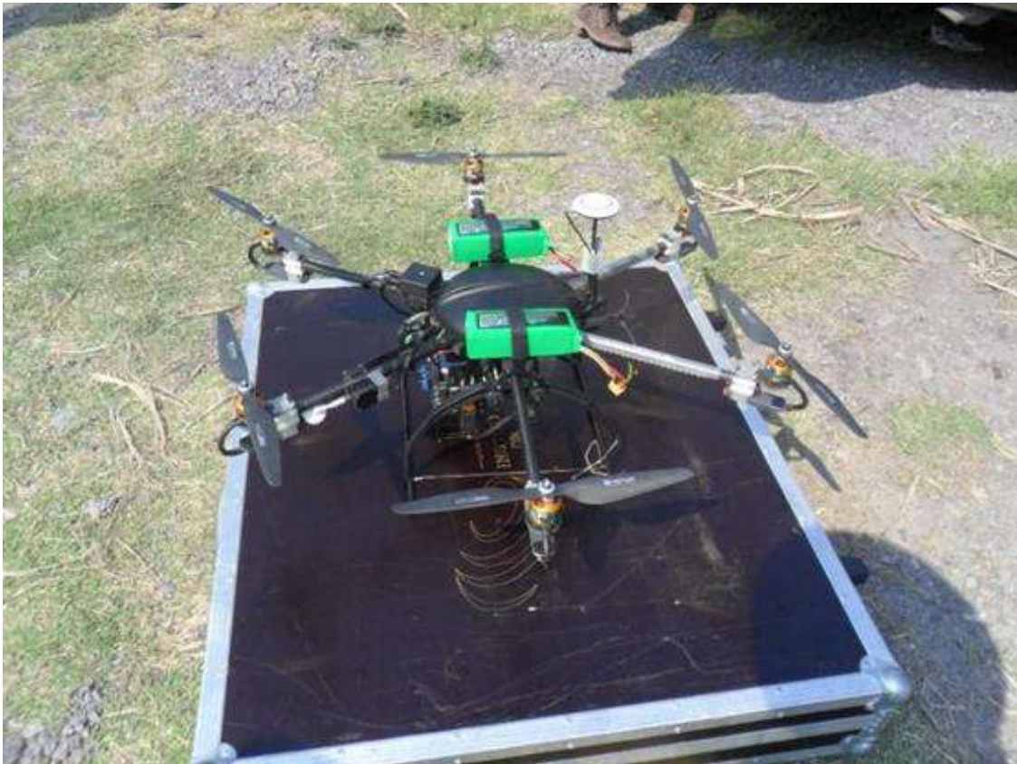
Figura 21: Zona de despegue de un dron tipo hexacóptero. Fuente: Uso y manejo de drones aplicados en la ingeniería (Bustamante, 2016).
