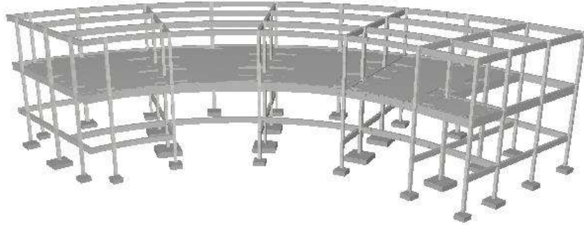
Figura A.5.4 Idealización de la estructura
