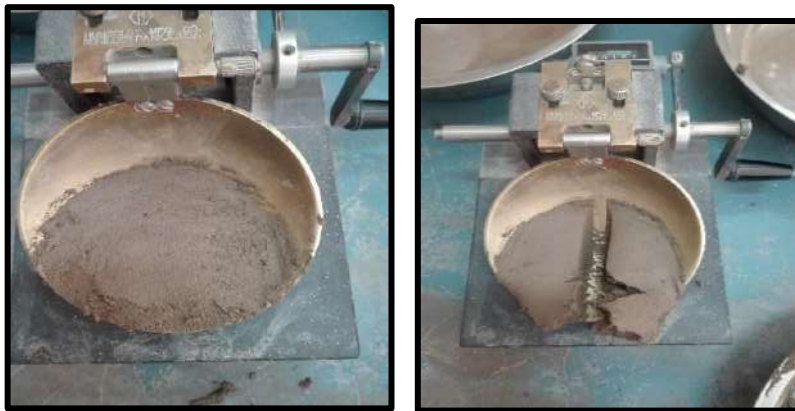
Imagen 9: Consistencia de los suelos Limite líquido y Limite plástico.
