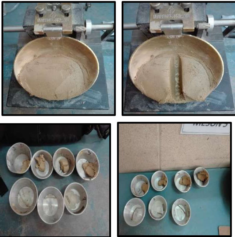
Imagen 6: Consistencia de los suelos Limite líquido y Limite plástico
