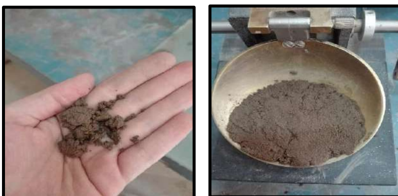
Imagen 12: Consistencia de los suelo Limite liquido Limite plástico.
