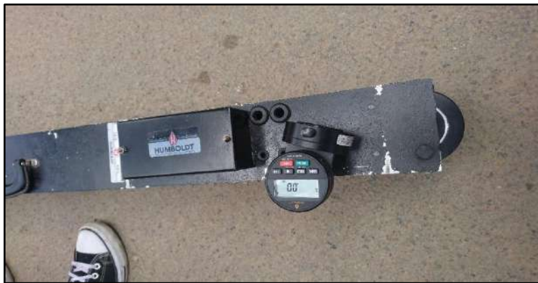
Imagen 2: Colocación de la viga benkelman en el sector donde se tomaran las mediciones
