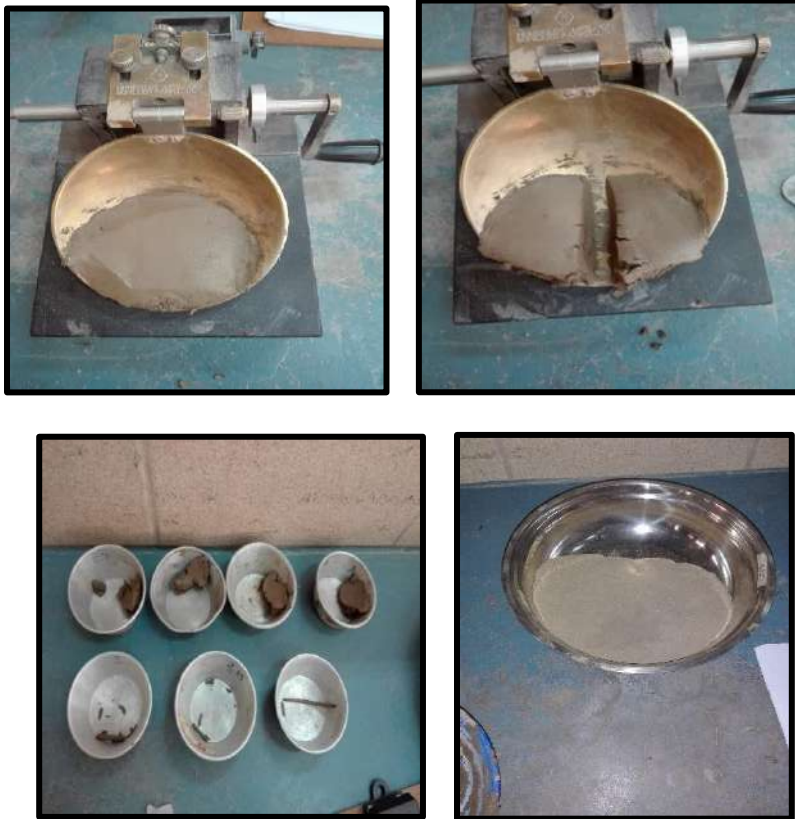
Imagen 3: Consistencia de los suelos Limite Liquido y Limite plástico.
