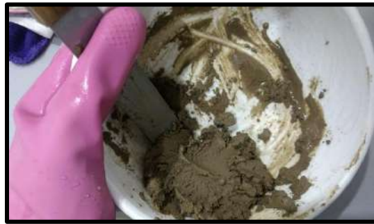
Imagen 18: Consistencia de los suelos limite líquido limite plástico.
