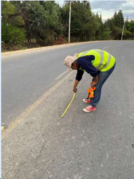
Punto de medición de falla
