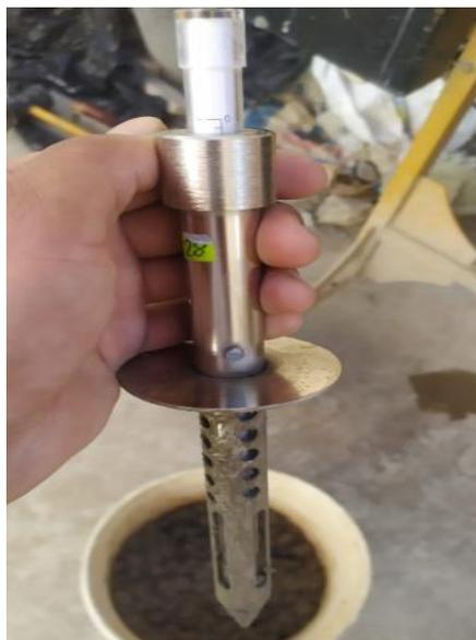
Como se puede ver, para consistencia seca no es recomendable, ya que el equipo solo mide un aproximado de 1/3 de del valor real, por la misma razón se descarta el uso del K-Slump para mezclas con consistencia seca.
