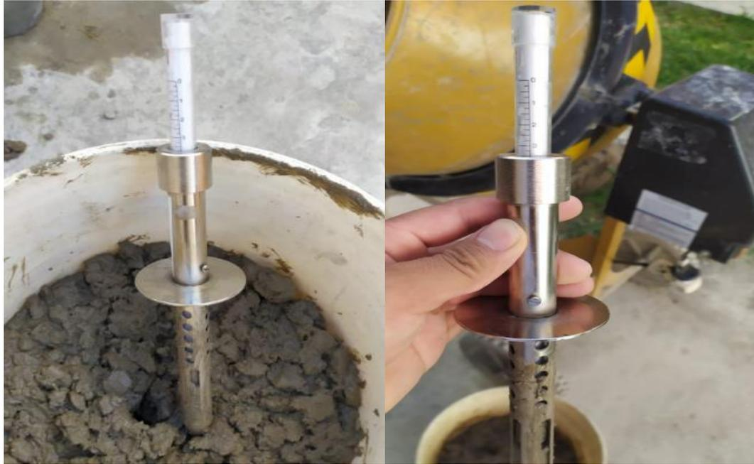
Se puede observar los valores de las mediciones con K-Slump, esto fue para mezclas con consistencia plástica tendiente a fluida, por lo que si es recomendable el uso del equipo para realizar mediciones de trabajabilidad de las mezclas de manera directa, pero dichas mezclas tienen que tener su consistencia en el rango de: Plástica-fluida.
