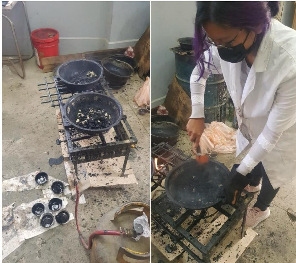
Elaboración de briquetas con mezclas asfálticas convencionales 85/100.
