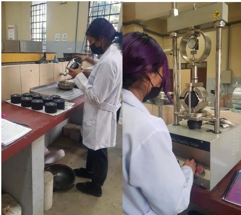
Se debe pesar y medir las briquetas para determinar sus propiedades mecánicas para posteriormente romper con la prensa Marshall.
