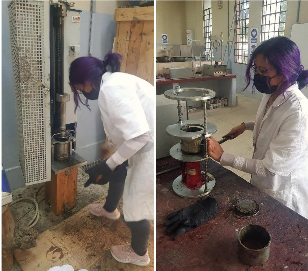
Se compacta aparato del martillo Marshall, con 75 golpes por cara, diseñado para tráfico pesado, posterior a su enfriado se desmolda en el gato hidráulico.
