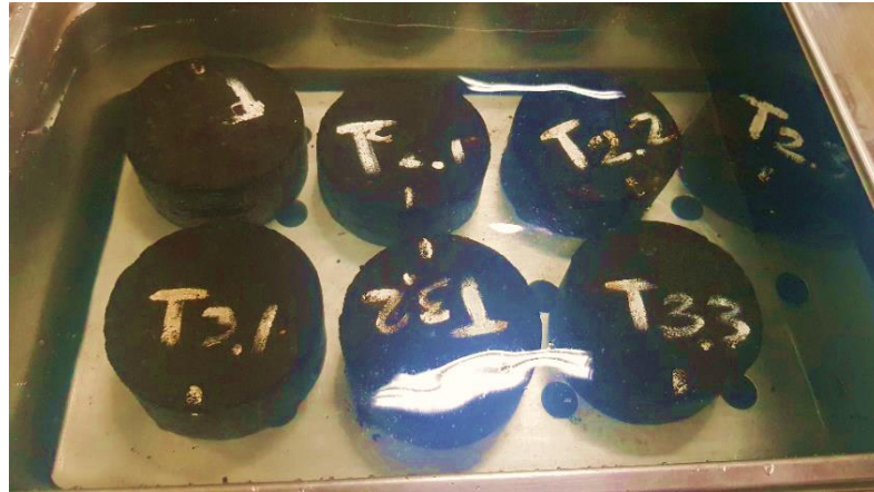
Figura 5.3. Baño María a 25°C antes de la rotura de briquetas
