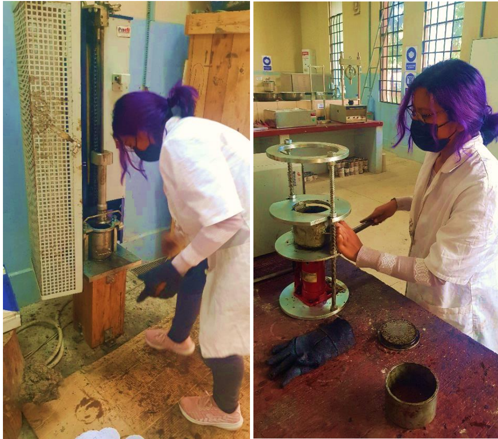
Figura 3.5. Compactación y desmolde de briquetas
