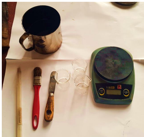
Figura 2.7. Materiales necesarios para el ensayo de peso específico del asfáltico
