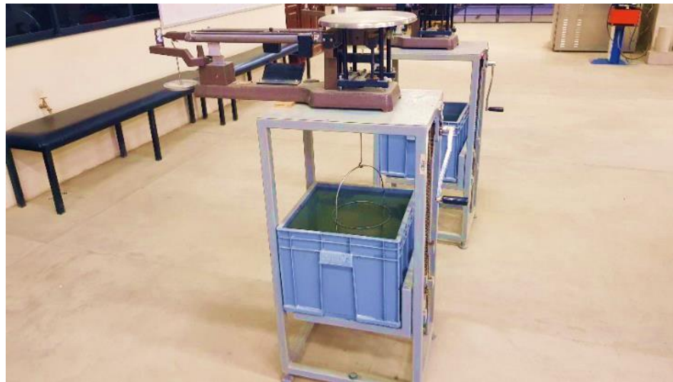
Figura 1.12. Canastillo para el peso sumergido de agregado grueso
