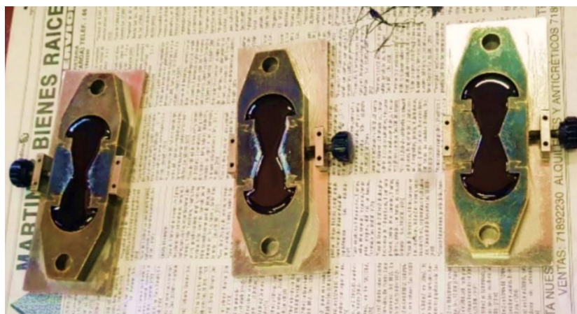
Figura 2.17. Moldes de ductilidad con cemento asfáltico 85/100.
