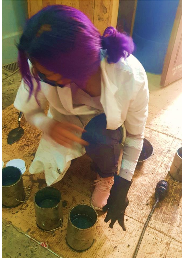
Figura 3.4. Colocación de la mezcla asfáltica en el molde de briquetas
