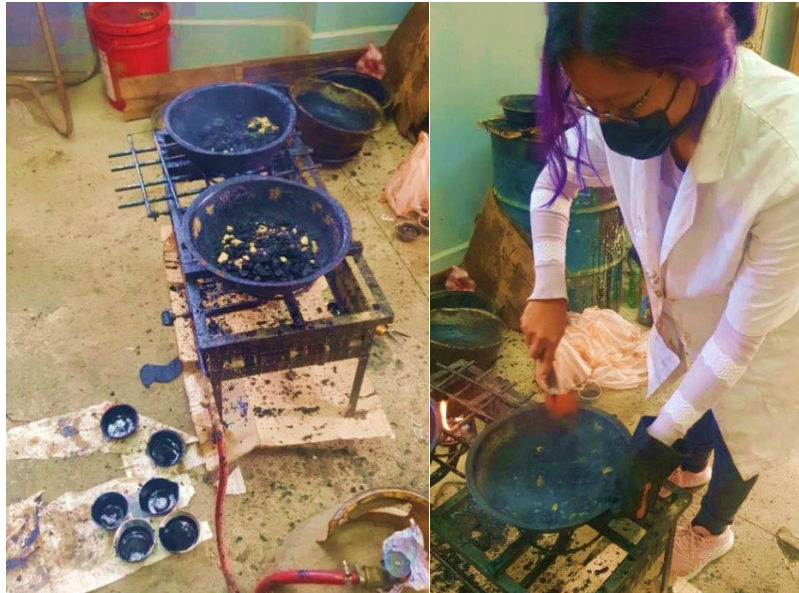
Figura 3.2. Mezcla homogénea de agregado y asfalto
