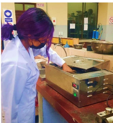
Figura 4.2. Inmersión de la briqueta en baño María a 25°C
