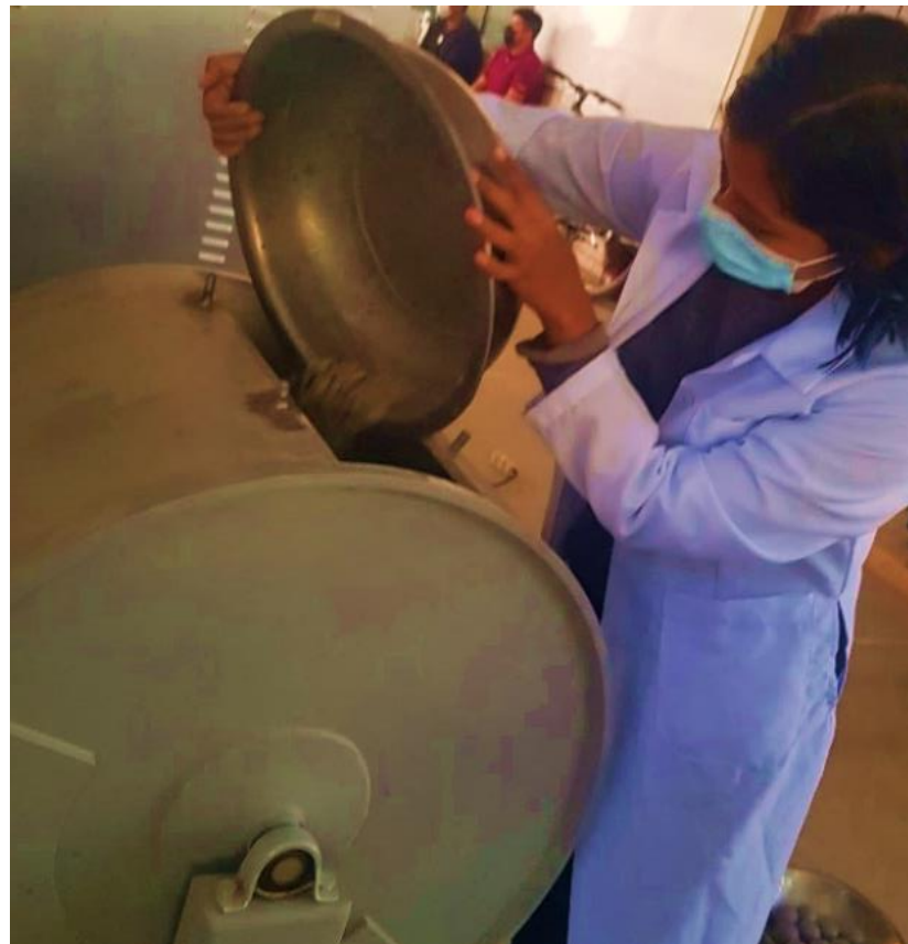
Figura 1.7. Realización del ensayo de desgaste de los Ángeles
