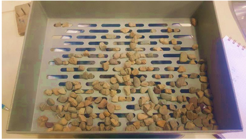
Figura 1.21. Aparato para realizar el ensayo para partículas laminares
