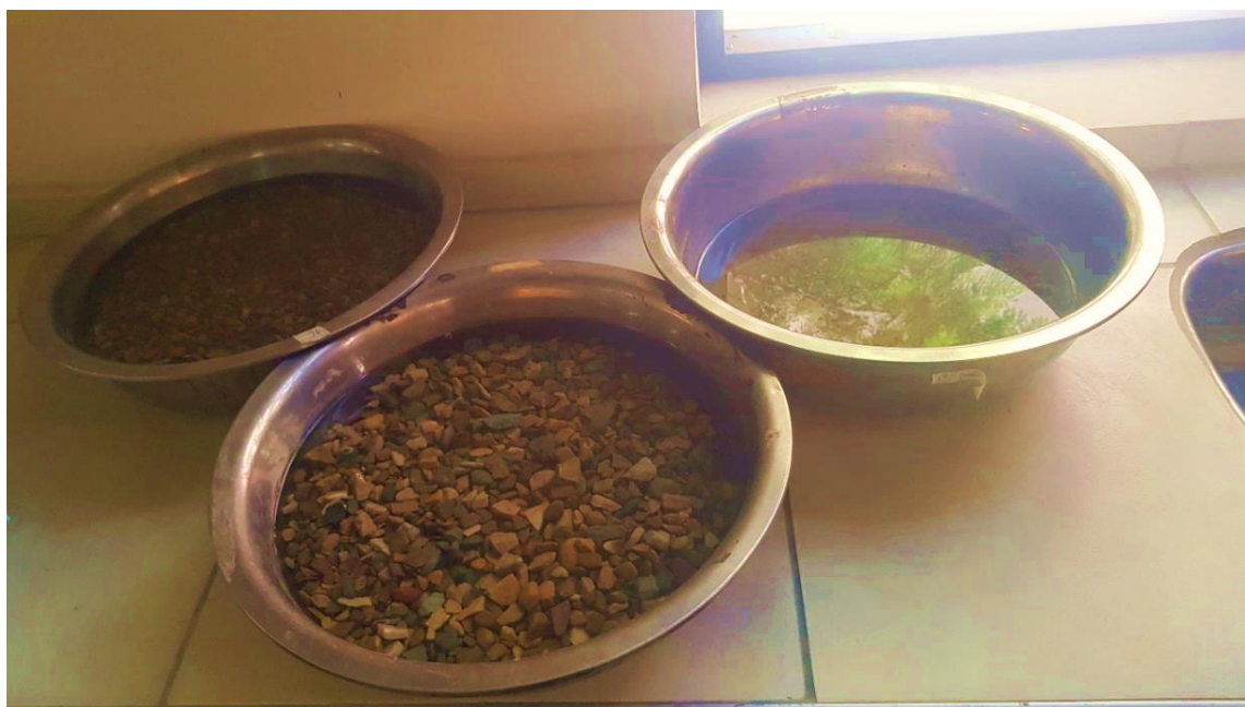
Figura 1.10. Saturación del agregado grueso
