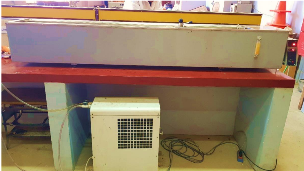
Figura 2.18. Equipo para la ductilidad
