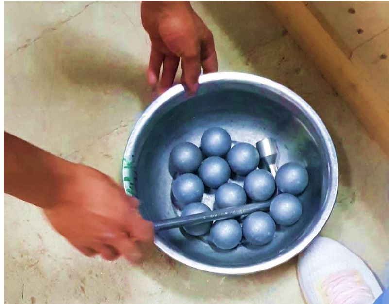
Figura 1.6. Esferas utilizadas para la carga abrasiva
