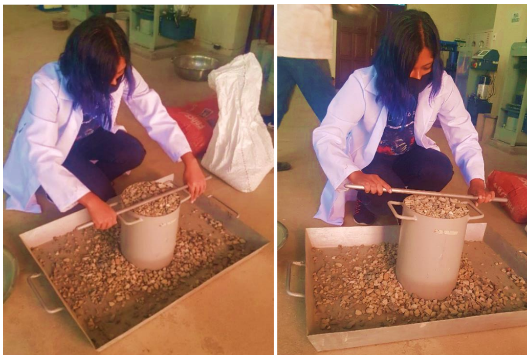
Figura 1.18. Enraizado del agregado grueso para el peso unitario suelto
