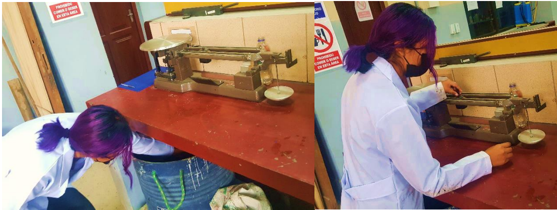
Figura 4.3. Determinación del peso sumergido de la briqueta
