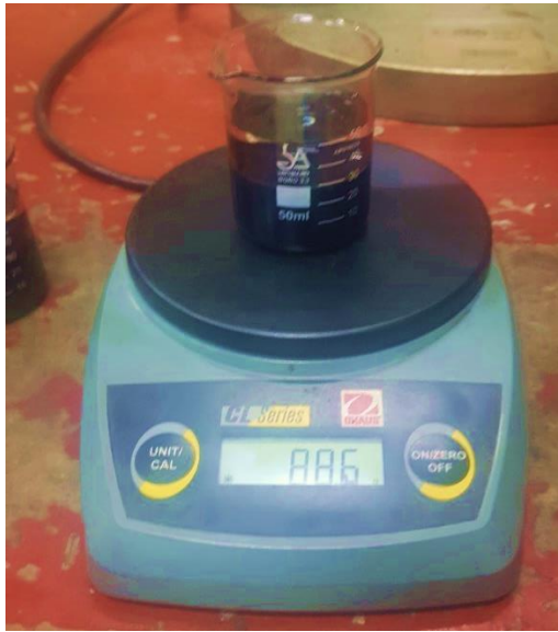
Figura 2.12. Peso de los frascos con cemento asfáltico más agua destilada
