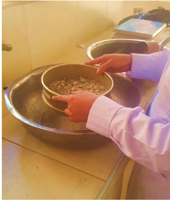
Figura 1.8. Tamizado del material por el tamiz N°12 después del ensayo
