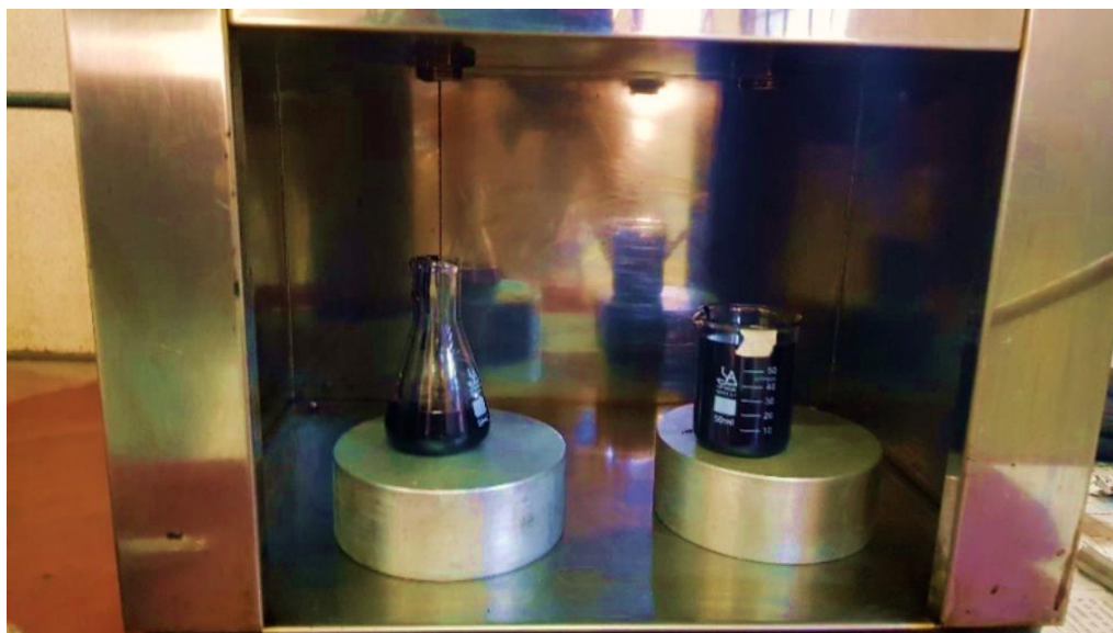
Figura 2.1. Ensayo de viscosidad Saybolt-Furol para el asfalto 85/100
