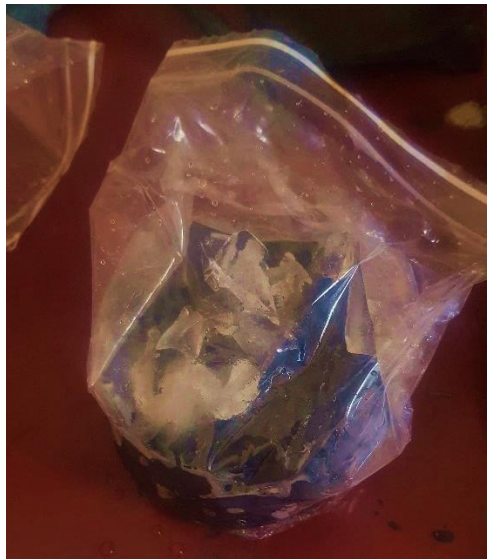
Figura 5.1. Congelación de briquetas para el ensayo de tracción indirecta
