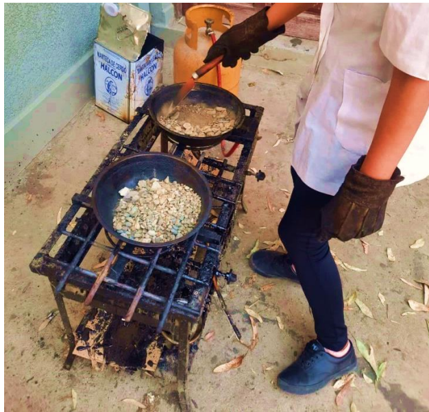
Figura 3.1. Calentamiento de los agregados para las briquetas
