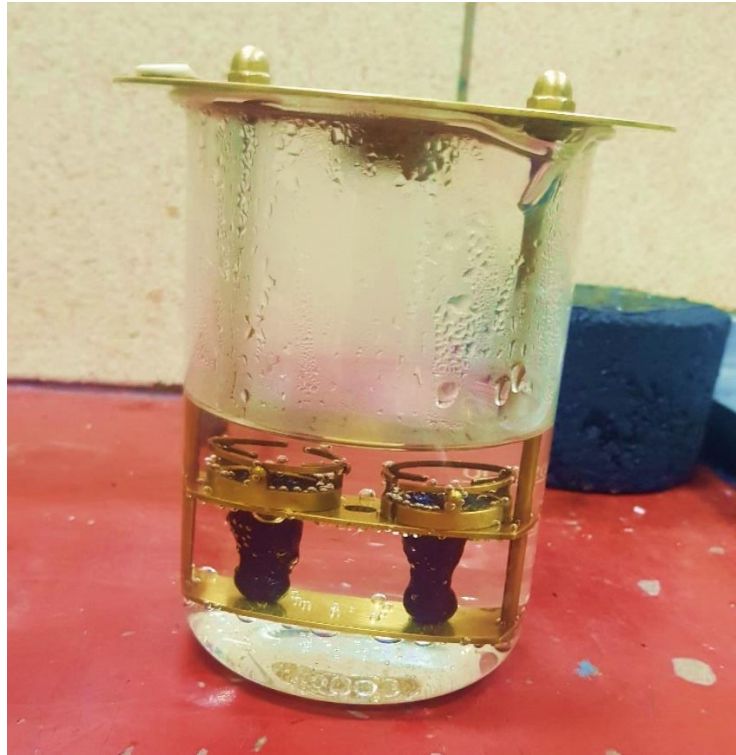
Figura 2.15. Finalización del ensayo de punto de ablandamiento
