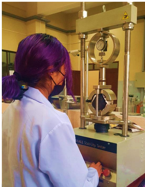
Figura 4.6. Rotura de briqueta en la prensa Marshall
