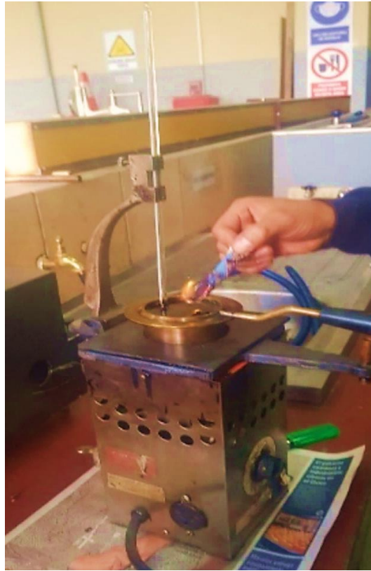
Figura 2.6. Aparato de punto de inflamación.
