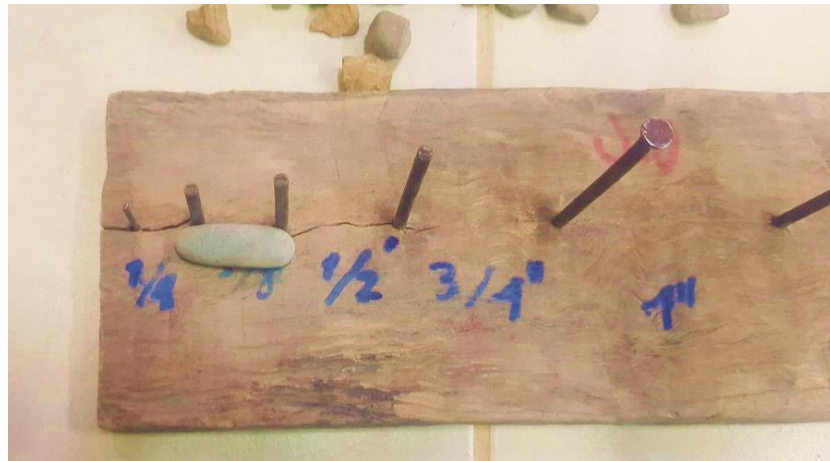
Figura 1.22. Aparato para realizar el ensayo para partículas chatas
