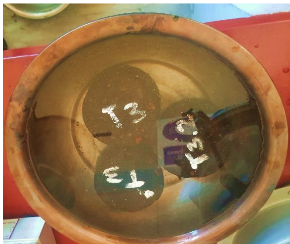
Figura 5.2. Saturación de briquetas en agua a 60°C
