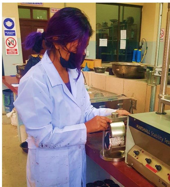
Figura 4.4. Colocación de la briqueta en la mordaza de la prensa.
