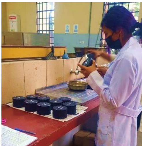
Figura 4.1. Medición de las alturas con las briquetas con el vernier
