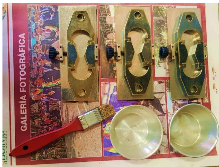
Figura 2.16. Materiales necesarios para el ensayo de ductilidad
