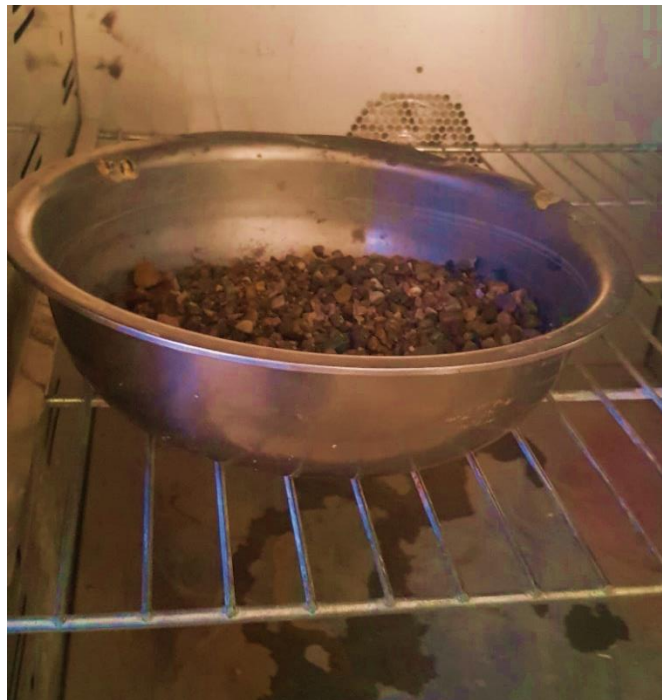
Figura 1.9. Secado del material retenido en el tamiz N°12
