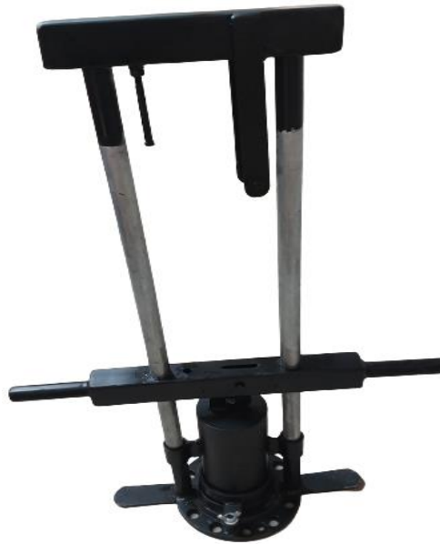
Figura 2.19 Equipo de Fragmentación Dinámica por Impacto utilizado
