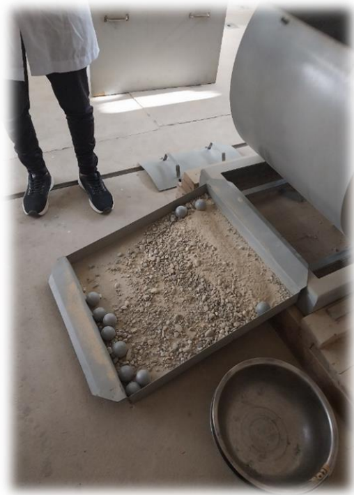
Vaciando la muestra luego de 500 revoluciones
