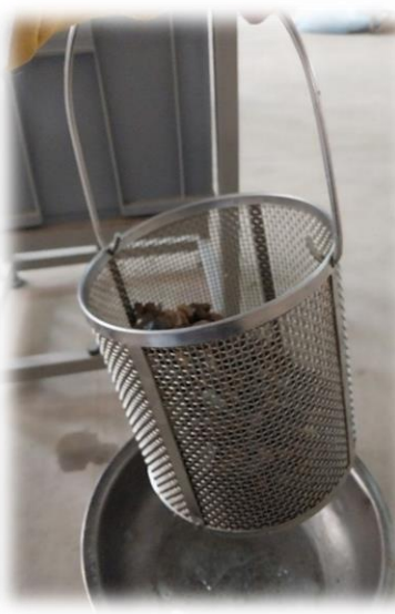
Calibración del equipo y pesado del agregado sumergido
