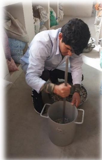
Compactado el agregado con 25 golpes en cada capa
