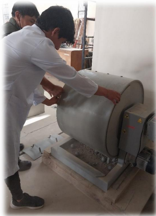
Vaciando la muestra luego de 500 revoluciones
