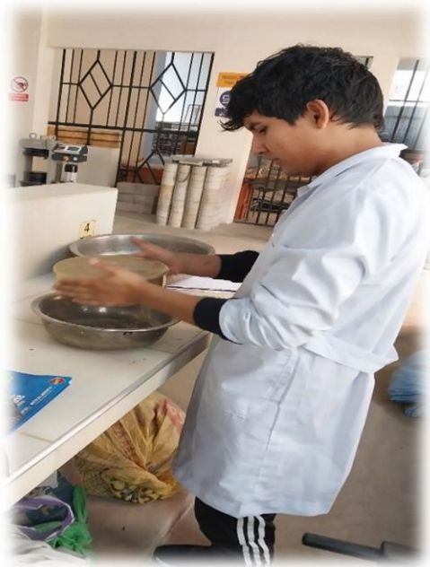
Tamizando la muestra por el tamiz N° 12
