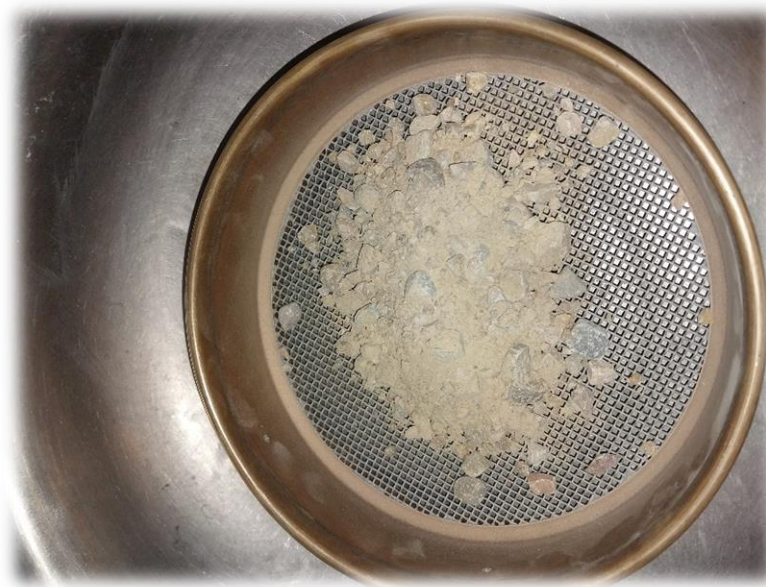
Vaciado del vaso al tamiz N° 8, luego de la prueba.
