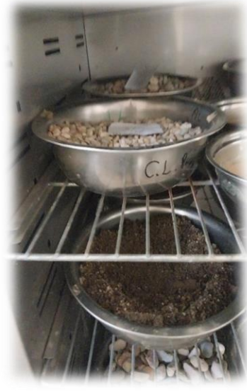
Secado en horno y posterior pesado
