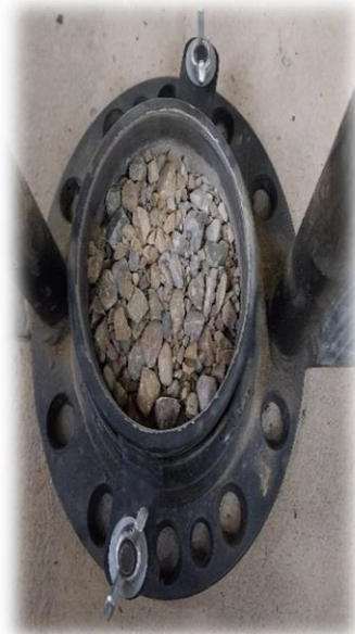
Aseguración del vaso a la base
