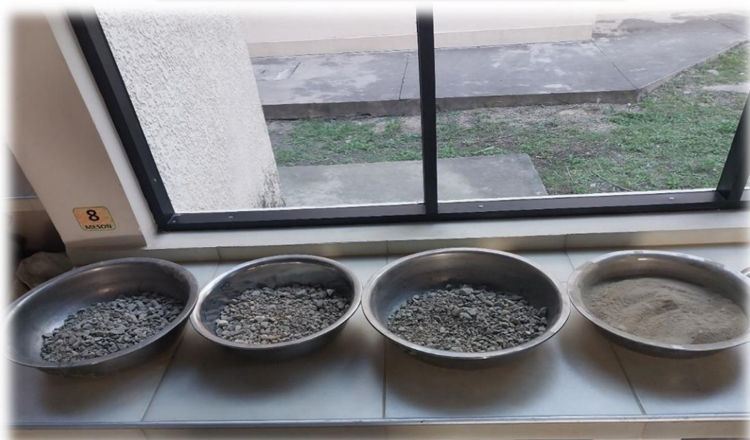
Muestras luego de ser tamizada por el tamiz N° 12
