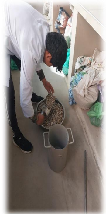
Llenado el molde por capas
