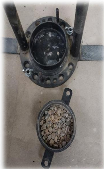
Fijación del vaso al equipo
