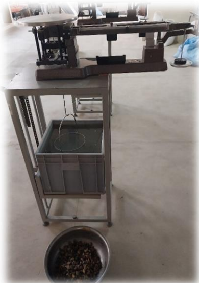
Calibración del equipo y pesado del agregado sumergido
