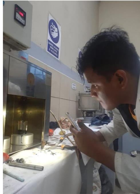
Foto 15: Ensayo de penetración al 1% de (HDPE)
