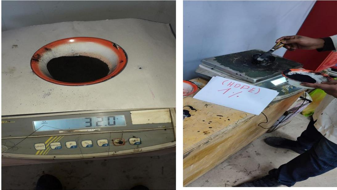
Foto 13: Mezclado del residuo de polietileno de alta densidad con el cemento asfáltico 85-
