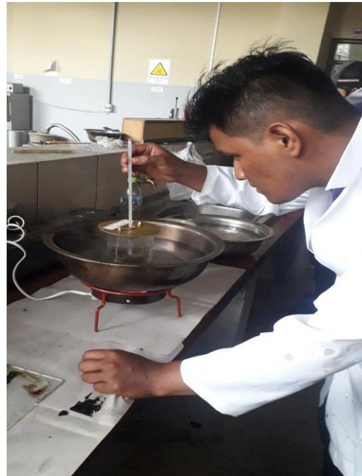
**Foto 10:** Ensayo de peso específico
