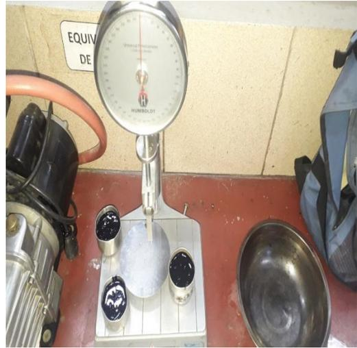
**Foto 6:** Ensayo de viscosidad saybolt furol
