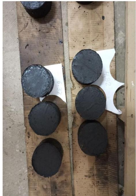
Foto 20: Rotura de probetas en el equipo de Marshall
