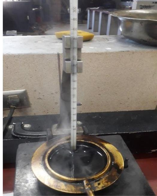
**Foto 9:** Ensayo de punto de ablandamiento
