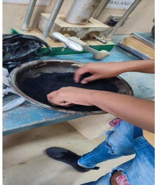
**Foto 4:** Granulometría del residuo de polietileno de alta densidad
