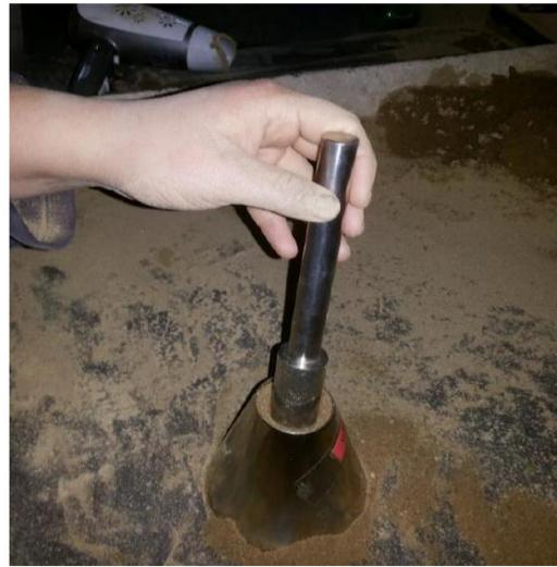
**Foto 18:** Ensayo de equivalente de arena
