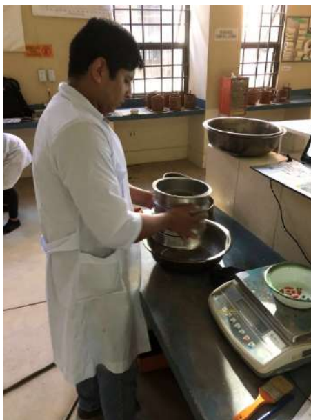
Figura 3.9. Ensayo granulométrico del talud N°(4-1)
