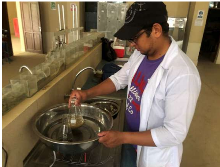
Figura 3.15. Ensayo contenido de humedad del talud N°(3-3)
