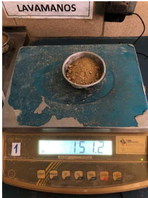
Figura 3.14. Ensayo contenido de humedad del talud N°(5-3)
