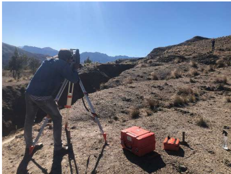
Figura 3.4. Levantamiento topográfico estación total Sokkia Set 5x
