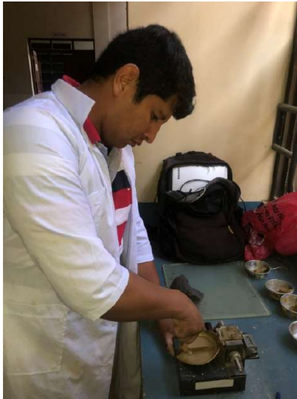
Figura 3.11. Ensayo limite líquido del talud N°(1-2)
