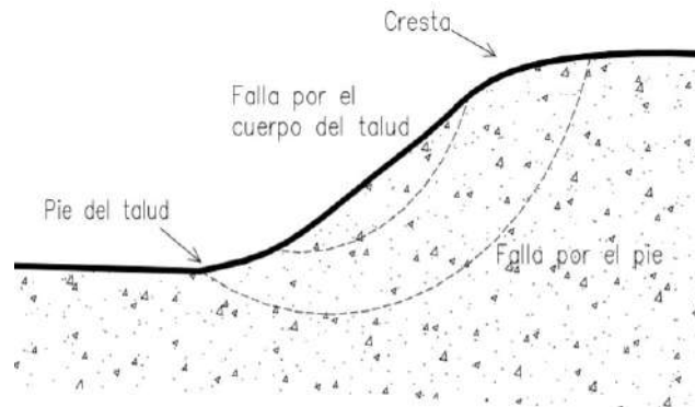
Figura 2.4. Falla por movimiento del cuerpo del talud
